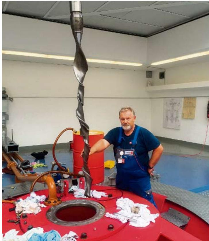
Was hier abgedreht daherkommt, ist normalerweise ein gerades Hydraulikrohr. In der Wasserturbine wird es zur Steuerung des Laufrades gebraucht. Bild zvg
